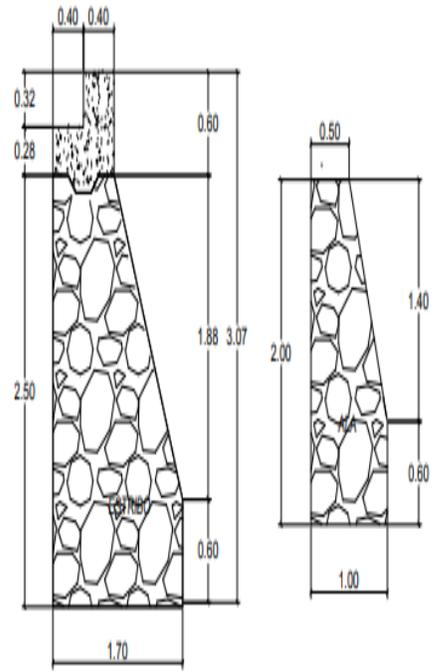
**SECCIÓN DE MUROS EN ESTRIBOS**
